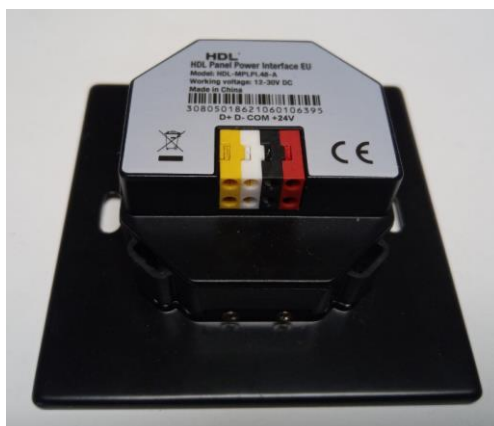
Slika 1.17 Sučelje za sabirnicu HDL koje se montira u razvodnu kutiju
