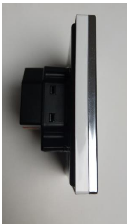
Slika 1.19 Bočni pogled na spojen modul zvona i modul sabirničkog sučelja
