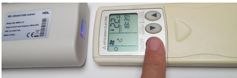
Slika 3.20 Snimanje IC koda s daljinskog upravljača klima-uređaja
