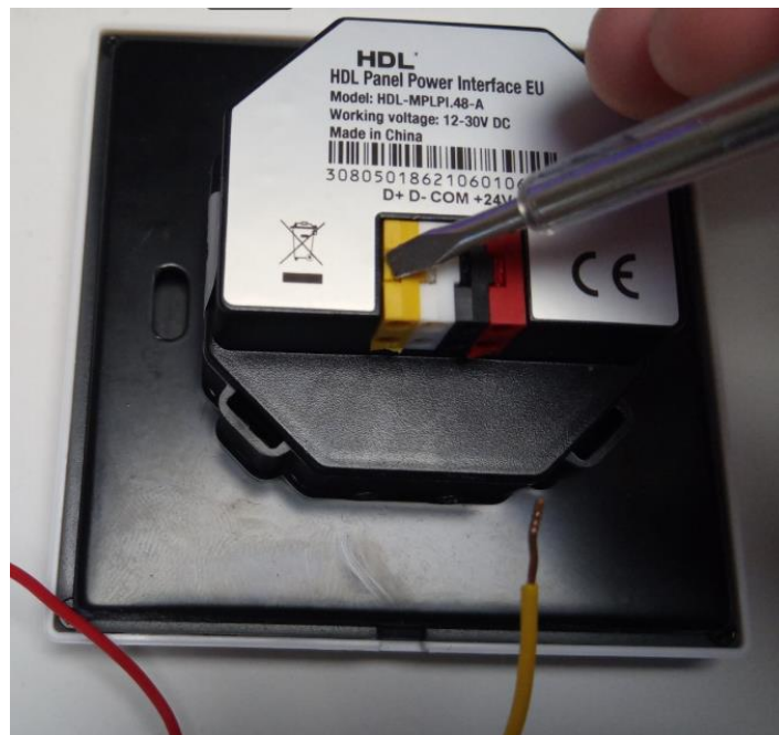
Slika 1.32 Pozicija pritiska na terminal za lakši rad s vodičima
