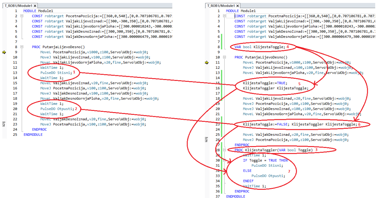
Slika 3.6.2.8 RobotStudio – prilagodba programa uvođenjem procedure KljestToggle u Module1
